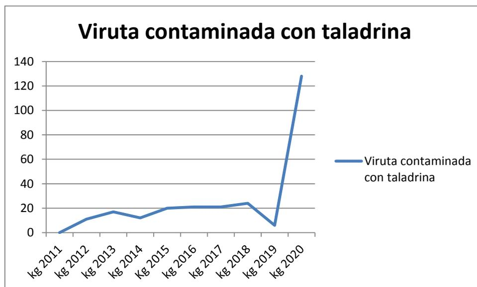
**Viruta contaminada con taladrinas:** derivados de los trabajos de mecanizado. Aunque se aprecia una reducción en los residuos, lo normal es la generación entre 15-25 kg al año. En 2020 se observa un aumento considerable, el cual se debe a lodo metálico derivado de la aspiradora con la que se limpia las máquinas AM250 y AM500.
